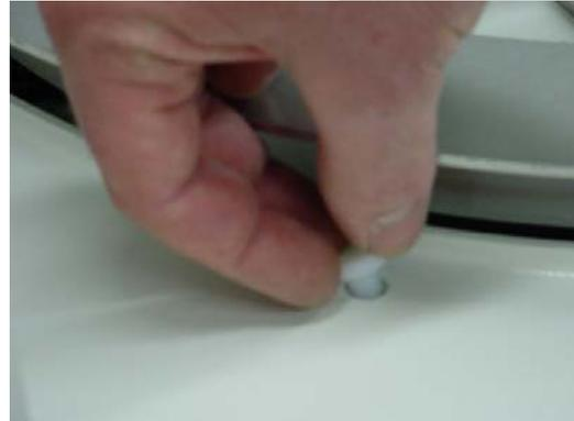
2. Danach drehen Sie die 3 weissen, im Lieferumfang enthaltenen, Kunststoffstopfen in die Befestigungsbohrungen der Transportsicherungen.
