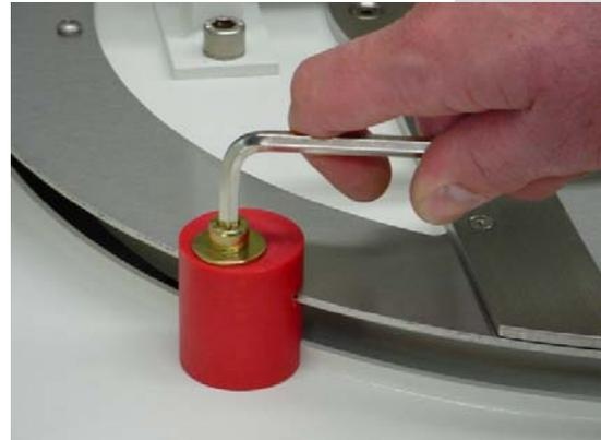
1. Entfernen Sie die 3 roten Transportsicherungen mittels des mitgelieferten Inbusschlüssels.
