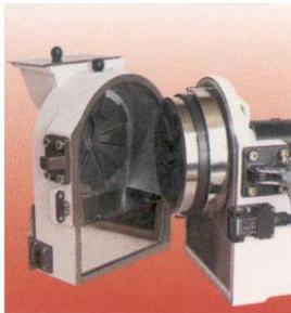
Die Zerkleinerung der Materialprobe erfolgt in einem nach außen staubdicht abgeschlossenen Mahlraum, in dem zwei innen grob verzahnte Mahlscheiben gegeneinander wirken. Von diesen wird eine durch einen kräftigen, langsam laufenden Getriebemotor angetrieben.
