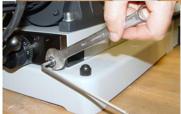
Nach Montage der neuen Mahlscheibe muss die Anschlagsschraube am Schlitten wieder justiert werden. Dazu wird der minimale Spalt von 0,1mm mit der Fühlerlehre und Kurbel eingestellt. Die Anschlagsschraube wird jetzt wieder nach vorne handfest bis zum Anschlag gedreht und mit der Kontermutter fixiert.
