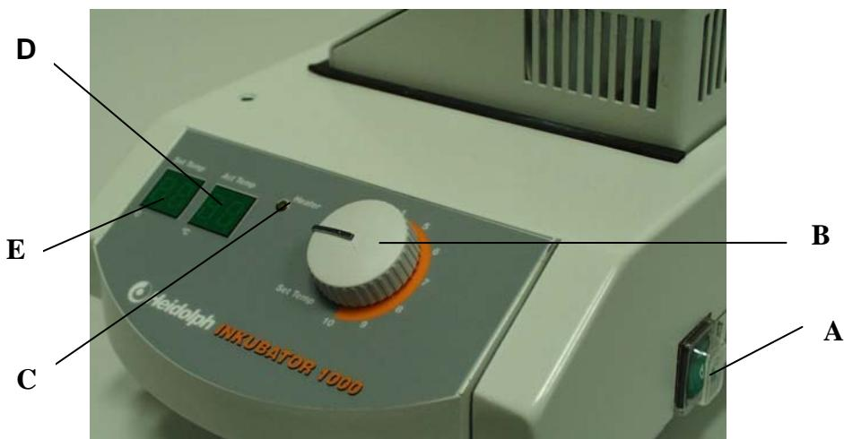
L'incubateur est prêt à fonctionner dès son branchement. La ventilation fonctionne en continu et assure la circulation d'air nécessaire.
